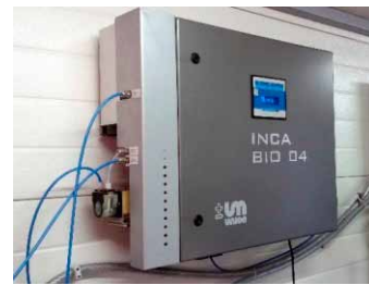
1 pav. Biodujų analizatorius INCA 4000 (autorius nuotrauka) Fig. 1. Biogas analyzer INCA 4000 (author's picture)
